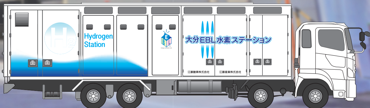
移動式水素供給設備で、燃料電池自動車に水素を供給します。
